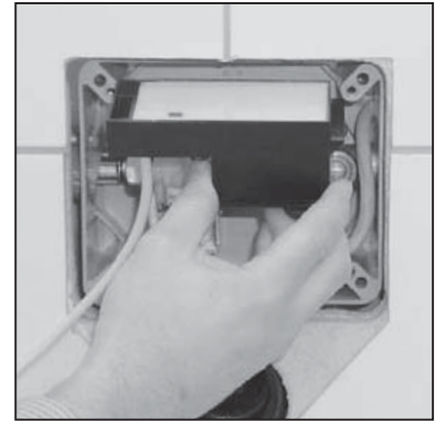
Elektronikmodul aus dem UPKasten entnehmen und die Stecker vom Magnetventil lösen.
